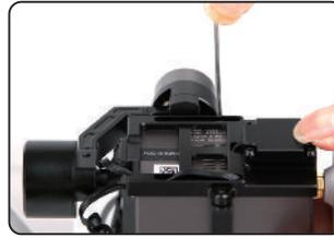
Installieren Sie die Kamera im Gimbal mit den beiden M2x4 Schrauben so das die Kameralinse frei bleibt.
