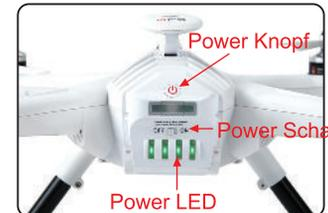
Stellen Sie die Drohne auf das Fahrwerk, schalten den Power Schalter ein und drücken den Power Knopf bis sich der Quadrocopter einschaltet.
