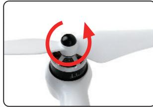
Ziehen Sie Propeller mit den passenden Markierungen von Hand an. Werkzeug wird nicht benötigt.
