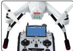
Halten Sie den Quadrocopter in horizontaler Position und warten ca. 40 Sek. bis die rote LED aufhört zu blinken, die Kalibrierung ist abgeschlossen.
