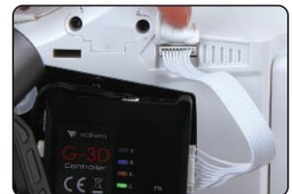
Schließen Sie das 9PIN weiße Datenkabel am "complex data port" unten am Quadrocopter an und verbinden es an der Rückseite des Gimbals.
