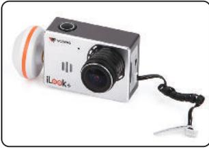
Schrauben Sie die weiße Pilzantenne in die Kamera und sichern diese vorsichtig mit dem beiliegenden Werkzeugschlüssel.
