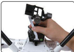
Schieben Sie den Gimbal in die Schnellbefestigungsschiene von vorne nach hinten komplett ein.
