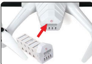
Installieren Sie den vollgeladenen Akku, schalten diesen aber nicht ! an. Bitte schauen Sie in die Hinweise zum Ladegerät, wie der Akku geladen wird.
