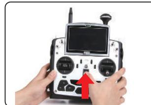
Bewegen Sie alle Trimmer in Mittelstellungen, Funktionsschalter auf 0 Position, Gas auf die unterste Position und schalten die Fernsteuerung ein
