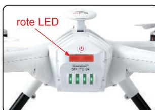
Innerhalb einer Minute wird die rote LED aufhören zu blinken, die Bindung ist erfolgt.
