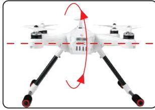
Vorwärts-Rotation. Rotieren Sie den Quadrocopter in 90° Grad Schritten und verharren alle 90° Grad 1 Sekunde lang in der jeweiligen Position.
