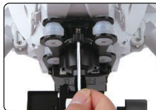
Installieren Sie die M3x12mm Federschraube um den Gimbal zu sichern.
